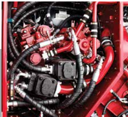
Bomba Parker de três estágios – maior vazão de óleo para os motores do picador
