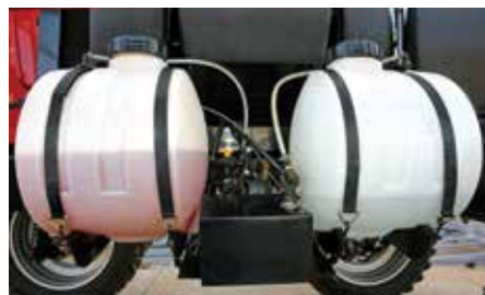
Tanques de injeção direta
